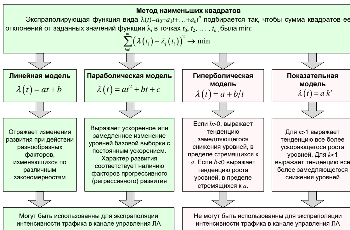
Рис. 2. Результаты анализа основных типов регрессионных моделей на предмет их соответствия априорным данным о границах изменения интенсивности трафика в канале управления БЛА
